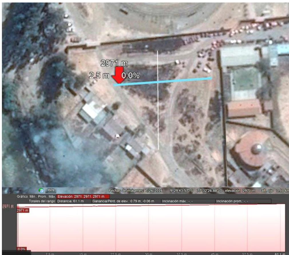
Figura 44: Perfil de la pendiente transversal. Adaptado de: Google Earth, 2016.
