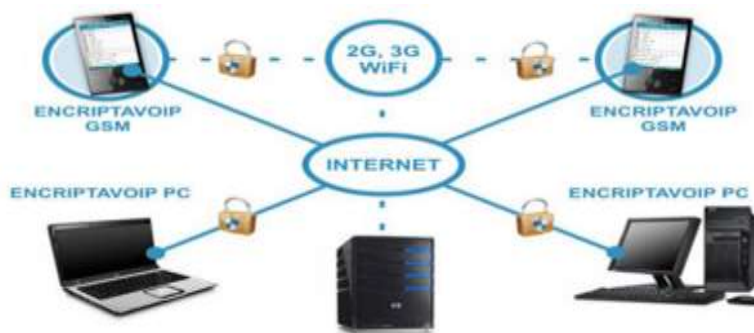
Figura 1. Esquema de Comunicación Segura. Se muestra las partes que intervienen para establecer una comunicación segura. Fuente: Tecnología avanzada en medidas y contramedidas electrónicas. TAMCE, 2016.
