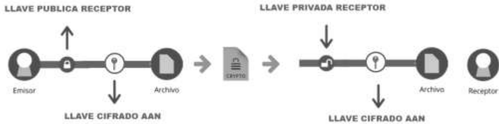
Figura 13. Proceso de cifrado. Se muestra el diagrama del proceso de cifrado del Algoritmo ANN.
