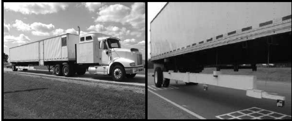
Fig. 55: El Rolling Wheel Deflectometer es un especial diseño de un remolque cojnmedidor láser montado en una viga bajo dicho remolque
