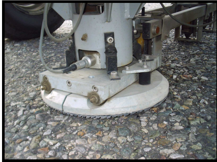
Fig. 47: Ensayos No Destructivos (FWD)
