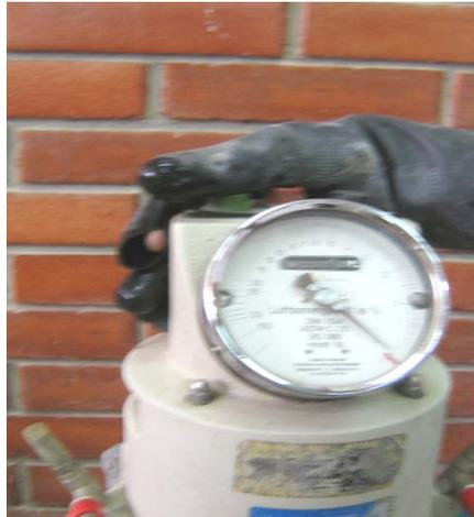
**Ajuste de los seguros para evitar fuga de aire**
