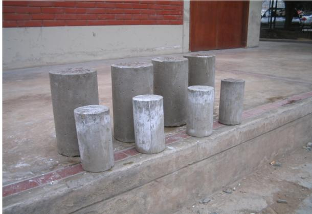
Muestras de probetas De 6"x 12" y 4"x 8"
