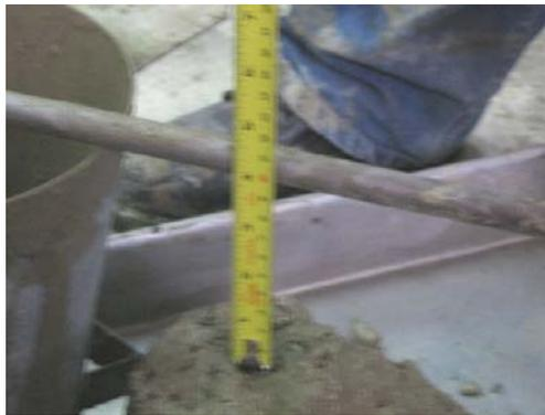
**Toma de Muestra del Ensayo de Slump**
