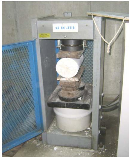
Acoplamiento de la maquina para el ensayo a tracción
