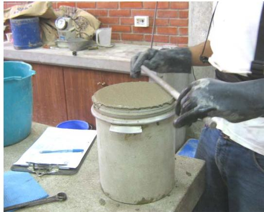
**Se enrasa el molde con una varilla para tomar el peso del concreto**
