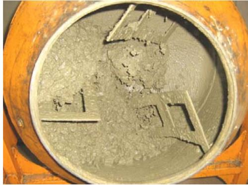
**Se mezclan los agregados alrededor de 5 min**
