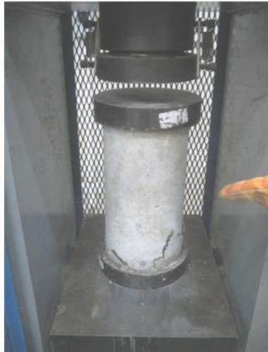
Ensayo de compresión en prensa automática (Tipo de falla cono)
