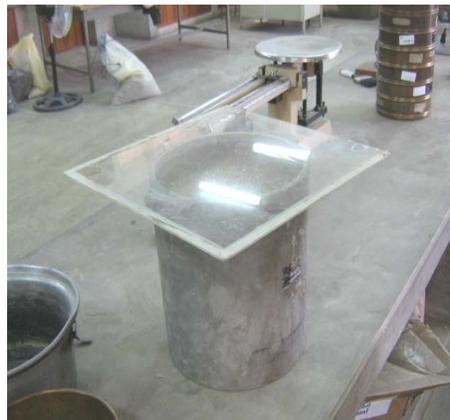
**El vidrio sirve para que el agua no se evapore para la Extracción del agua exudada del concreto**
