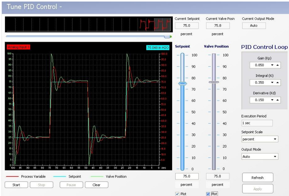
Fig. 2.20 Gráfica de salida de la señal de control en un computador de flujo Cortesía: Cameron Measurement Systems
