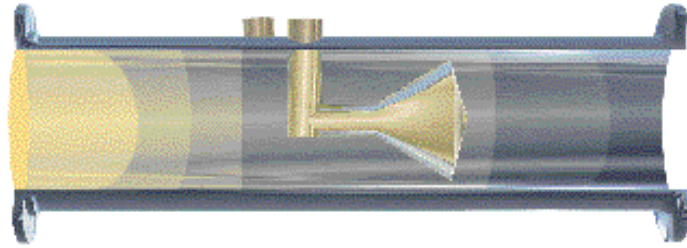
Figura 2.14 Sensor tipo Cono, vista interior dentro de la tubería
