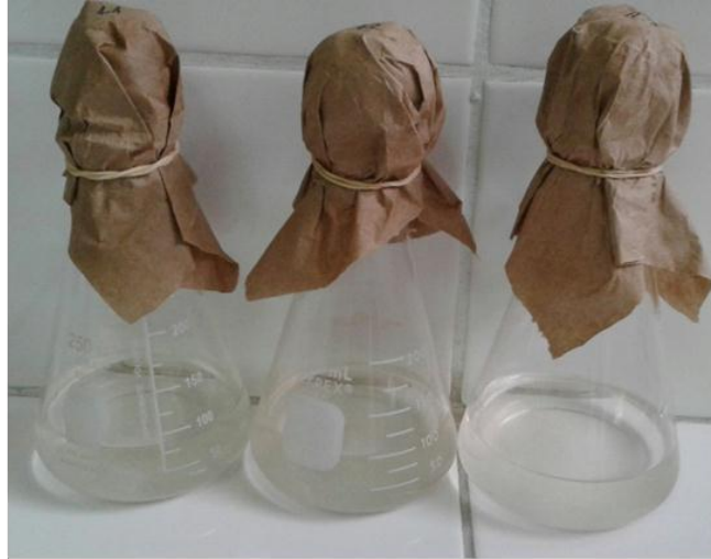
Figura N°4. Matracas con 100 mL de solución diluyente estéril (agua pertonada). Para la obtención de la carga microbiana inicial y final por el método de enjuague de los envases de policarbonato
