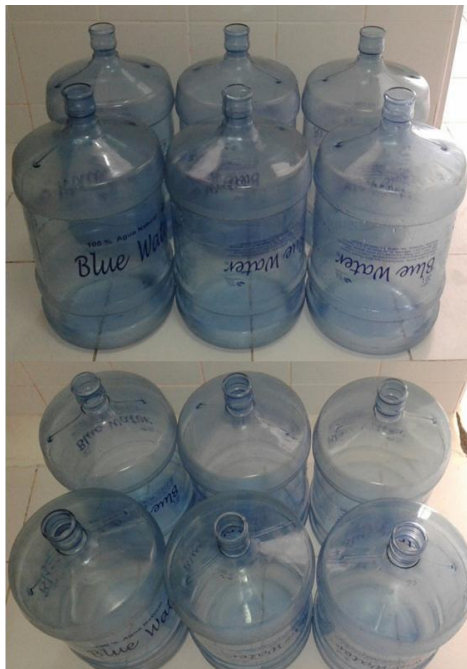
Figura N°3. Envases de policarbonato tratados con las diferentes concentraciones de detergentes industriales y desinfectantes.
