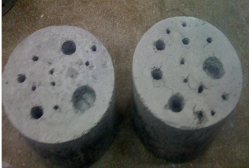
Muestras después de realizado ensayo con penetrómetro de Acme
