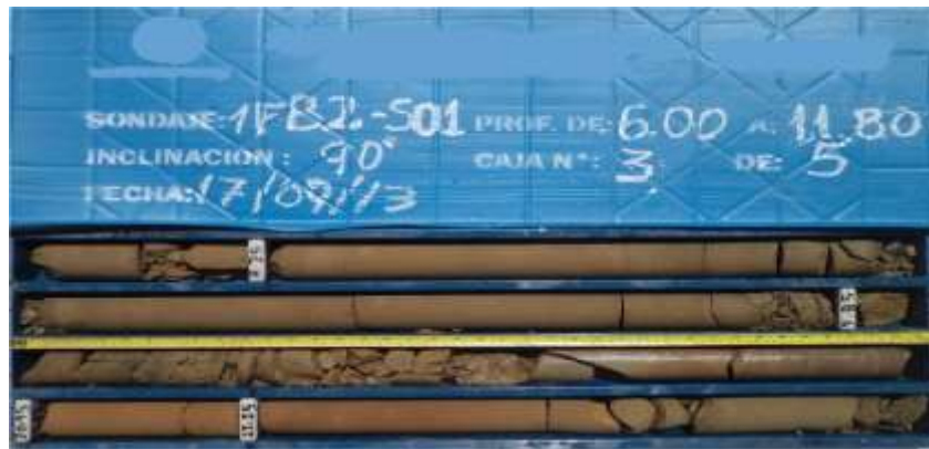
Figura 6: Caja de portatestigos de sondeo geotécnico.
