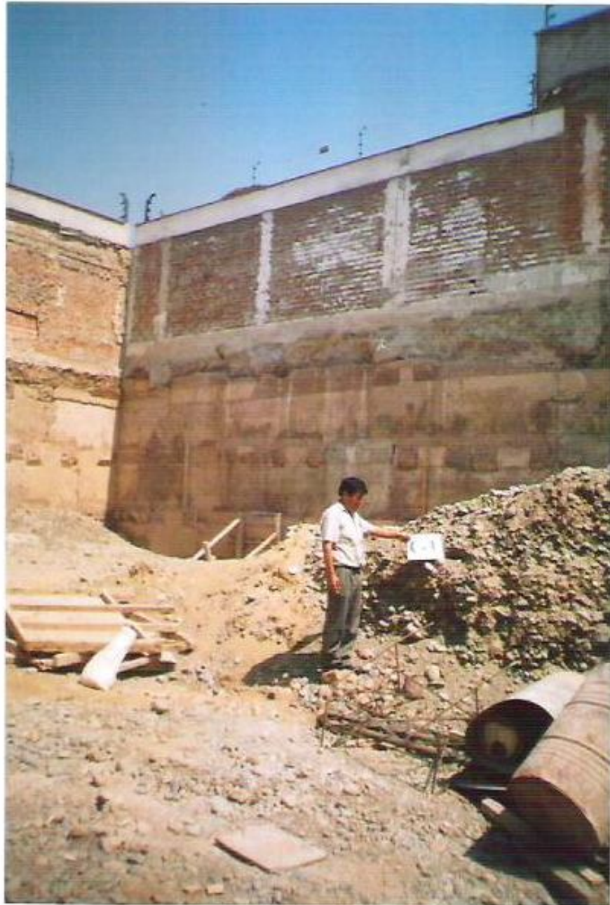
FOTO N° 7.- Vista del perfil estratigráfico C-3, el mismo que está constituido arenosa pobremente graduada, del tipo GP, no plástica y mediana a densa conforme se avanza en profundidad.
