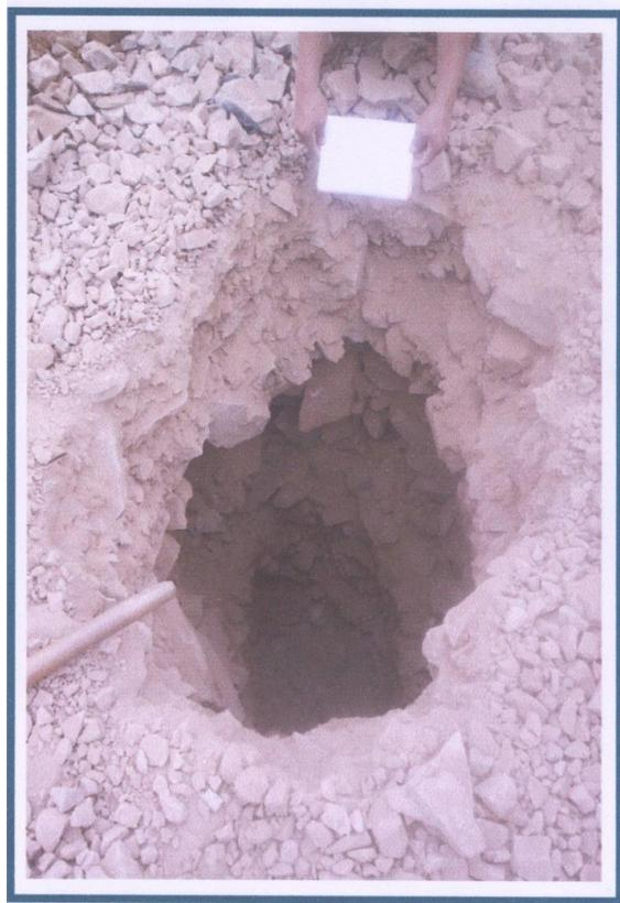
**FOTO N°22:** Pozo C-8 Superficialmente y hasta la profundidad de 1,10m, presenta material de relleno de grava arenosa, poco limosa, con presencia de cantos y boleos , color beige, continuando y hasta la profundidad explorada de 3,00m con grava arenosa,poco limosa, con presencia de cantos y boleos, color marrón claro.
