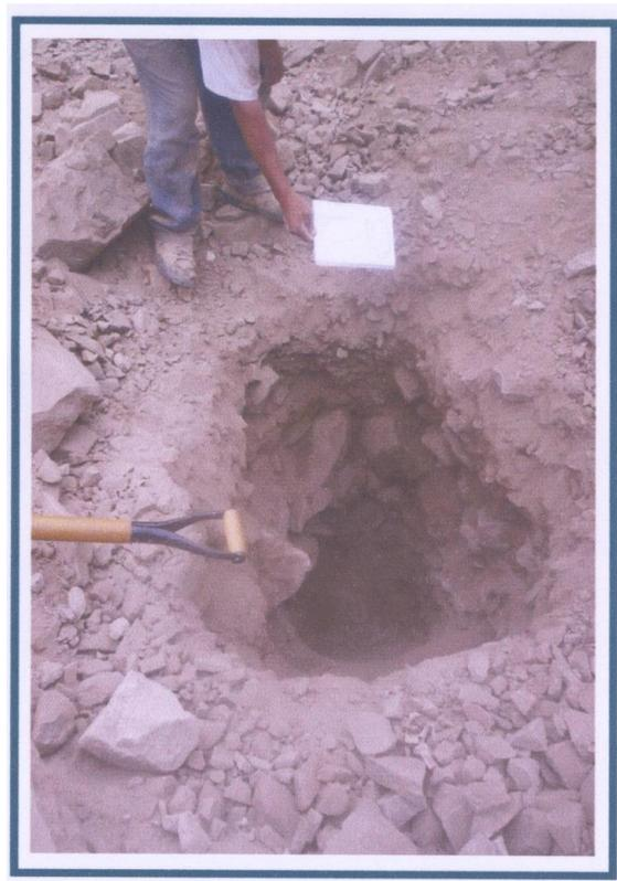
**FOTO N°26:** Pozo C-10 Superficialmente y hasta la profundidad de 2,00m, presenta material de relleno de grava arenosa, poco limosa, con presencia de cantos y boleas, color beige, continuando y hasta la profundidad explorada de 3,00m con boleas de hasta 20" con matriz grava limosa .
