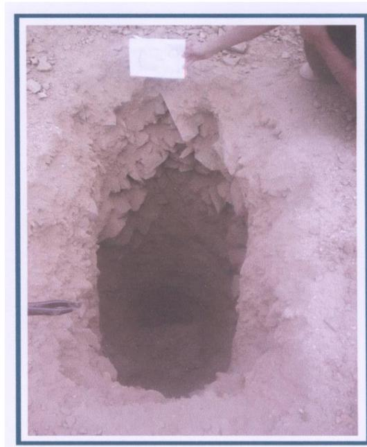
**FOTO N°24:** Pozo C-9 Superficialmente y hasta la profundidad de 1,00m presenta material de relleno de grava arenosa, poco limosa, con presencia de cantos y boleos, color beige, continuando y hasta la profundidad explorada de 3,00m con grava arenosa, poco limosa, color beige.
