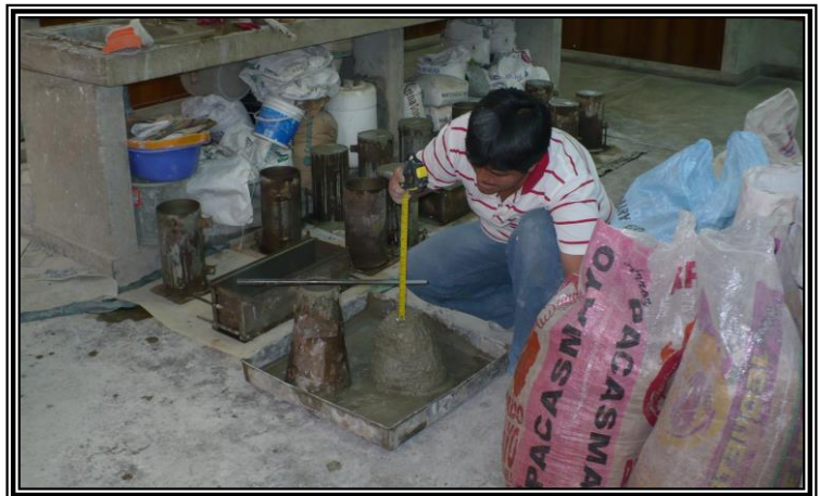
OBTENCIÓN DEL SLUMP EN DISEÑO FINAL DEL CONCRETO PATRÓN
