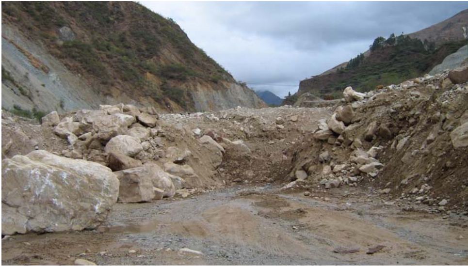
Foto 5 - Cantera Culebrillas: Estrangulamiento en el punto de carguío este (22/09/06).
