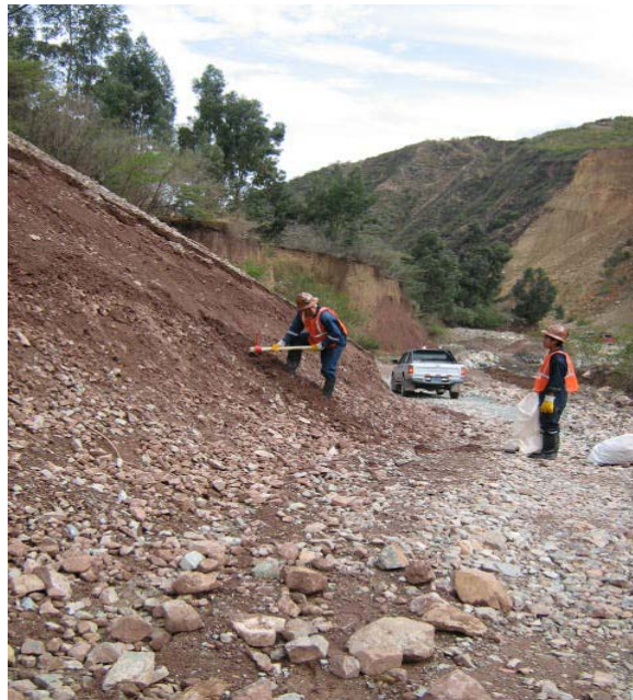
Foto 17 - Cantera Culebrillas-Chilcapampa: Muestreo de material como suelo de baja permeabilidad (19/09/06).
