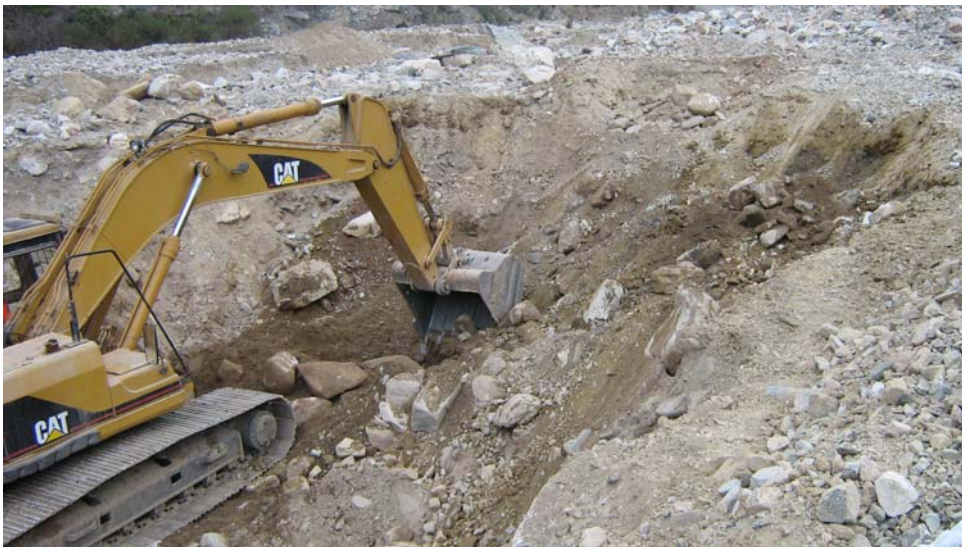
Foto 2 - Cantera Culebrillas: Explotación del extremo este. Potencia ente 4 y 5m (16/09/06).
