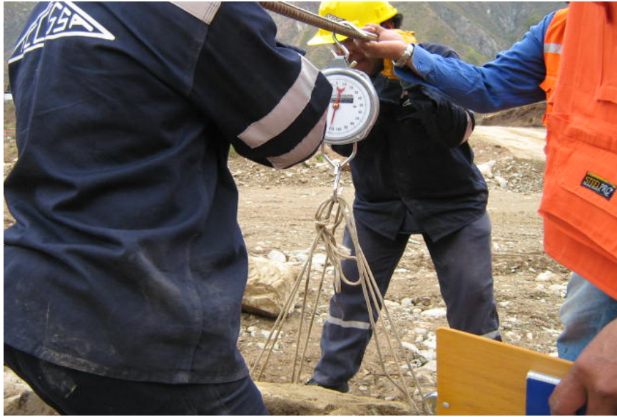
Foto 30: Presa Alpamarca – Pesaje de las gravas en campo – Granulometría global (15/09/06).
