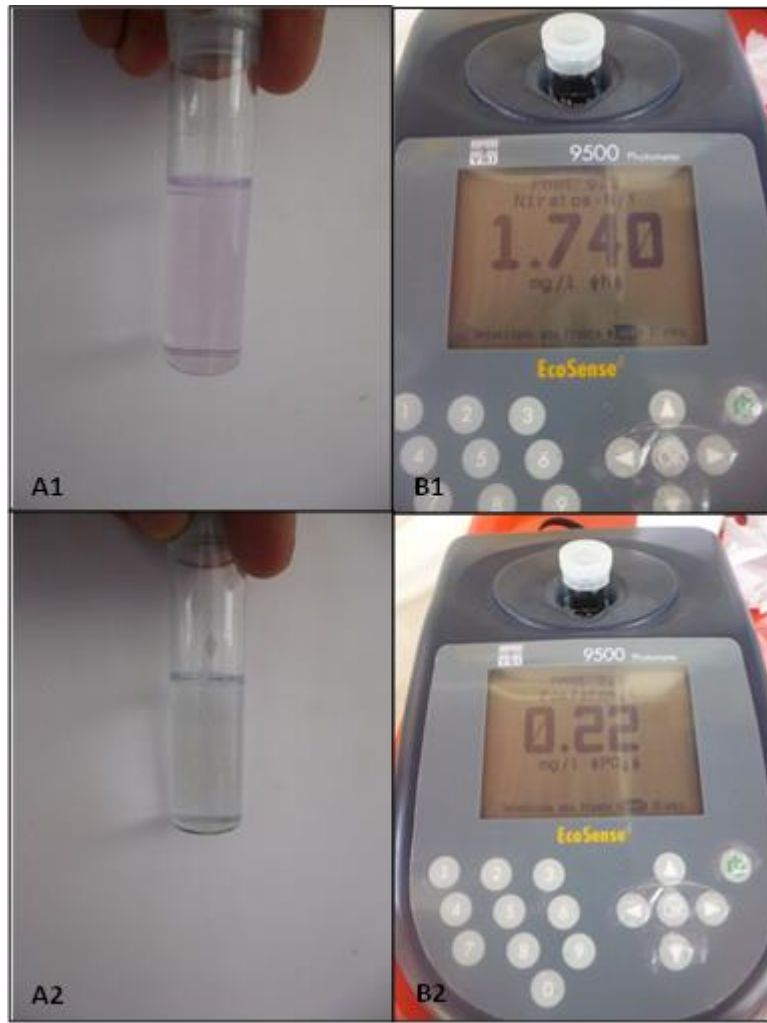
Figura 6. Cuantificación de \text{N-NO}_3^- y \text{PO}_4^{3-} mediante las técnicas colorimétricas de reducción/diazotización y azul de molibdeno, respectivamente. A1: la coloración rosada indica la presencia de \text{N-NO}_3^- . A2: la coloración azulada indica la presencia de \text{PO}_4^{3-} . B1 y B2: lecturas para cada nutriente en el fotómetro YSI 9500.
