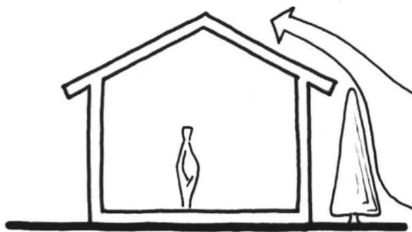
Ilustración 6: Protección de vientos en una edificación. Fuente: Fuente: Wieser, Martin. Consideraciones Bioclimáticas en el diseño Arquitectónico: El Caso Peruano.
