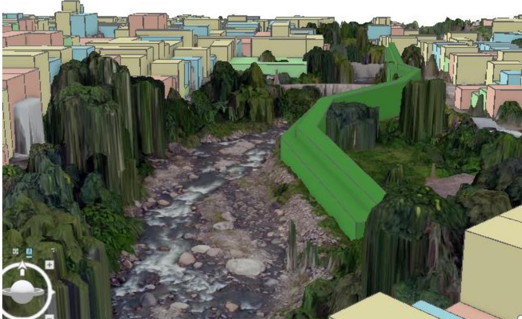
Figura 40: Vista del Río San Ramón en 3D con gaviones de altura de 5m
