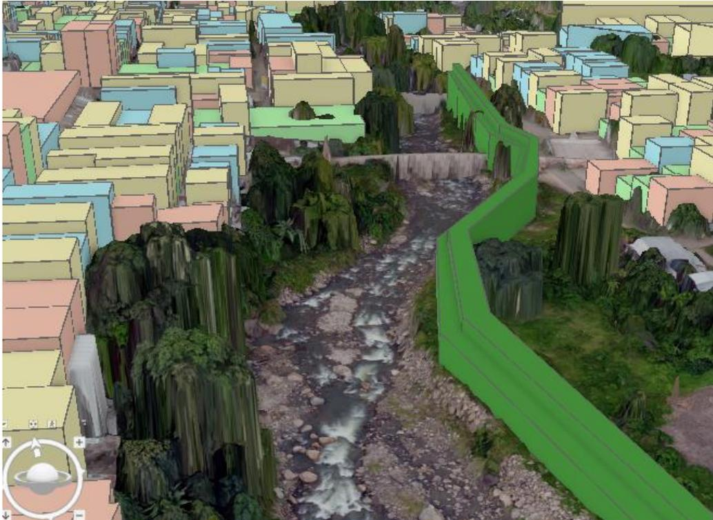
Figura 41: Vista del Río San Ramón en 3D con sus gaviones de altura de 5m
