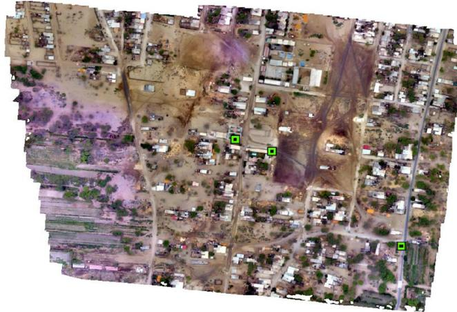
Figura 50. Ortofoto vuelo1-70m, con tres puntos de control
