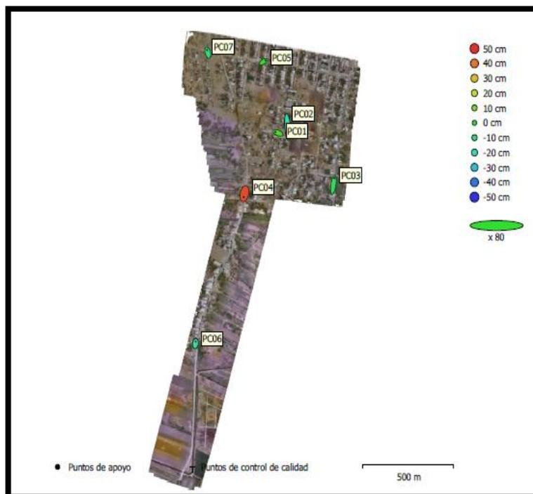
Figura 43. Ortografía de vuelo de 90 metros con puntos de control
