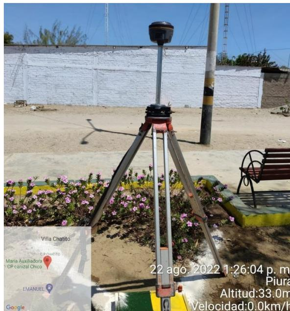
*Figura 36.* Posicionamiento del GPS South
