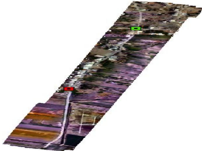
Figura 58. Ortofoto vuelo3 -70m, con dos puntos de control.
