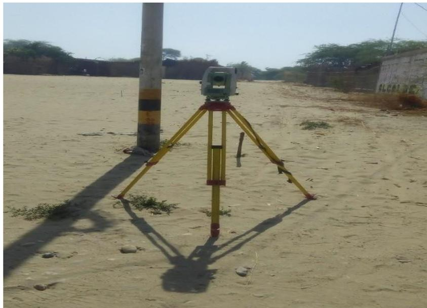
*Figura 32.* Estación Total en posicionamiento de PC 02 C.P Canizal Chico
