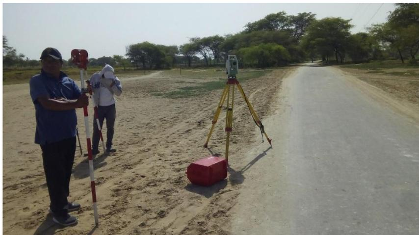
*Figura 34.* Lectura de puntos con el prisma de los extremos de la vía
