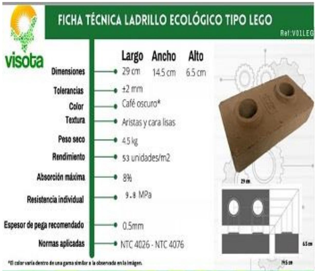
*Nota.* Se puede observar la ficha técnica del ladrillo tipo Lego prefabricado a base de RCD.
