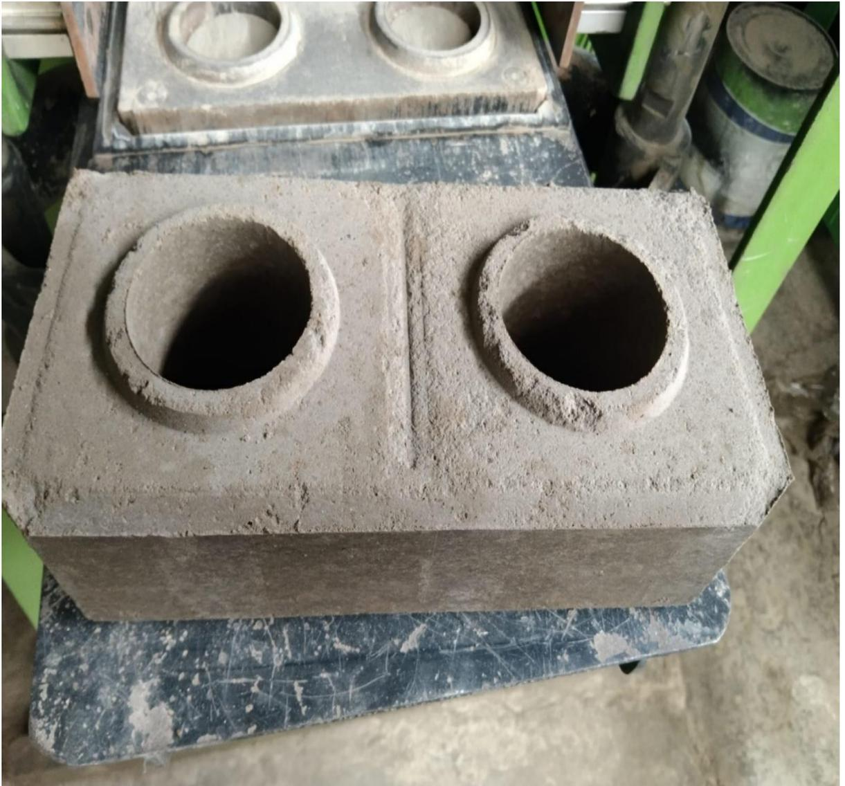
*Nota.* Ladrillo tipo Lego a partir del reciclaje de las RCD. Elaboración propia
