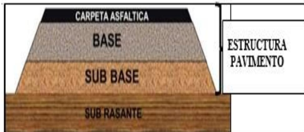
Figura 9. Estructura de los pavimentos flexibles.
