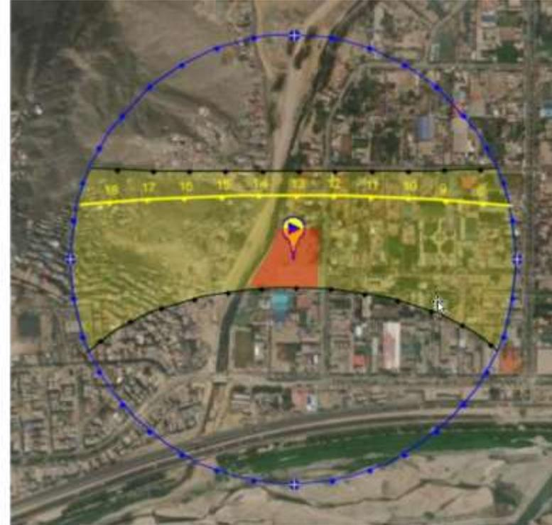
*Nota:* En el mes de abril existe mayor exposición solar y radiación ultravioleta, el recorrido va desde el este al oeste. Se observa la salida del sol desde el este (cara trasera del terreno y puesta por el oeste (cara frontal del terreno)).
