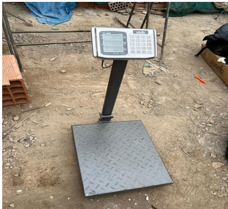
Figura 21. Balanza electrónica de 300 kg.
