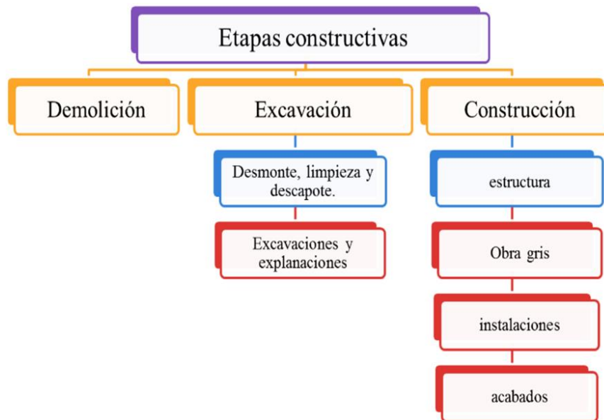
Figura 7. Etapas constructivas generadoras de RCD.
