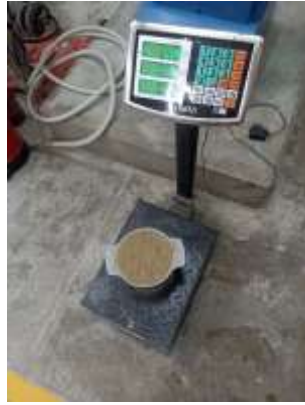
Foto 6: Peso de la muestra suelta.
