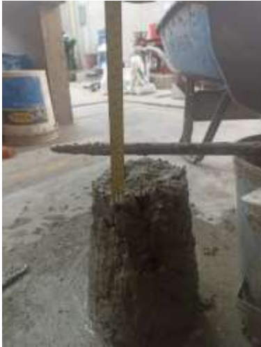
Foto 18: Ensayo de slump.
