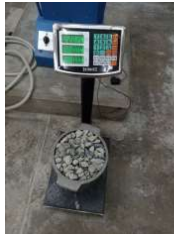
Foto 9: Peso de la muestra compactada.
