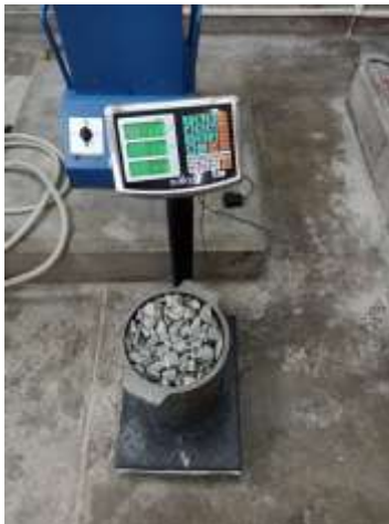
Foto 8: Peso de la muestra suelta.
