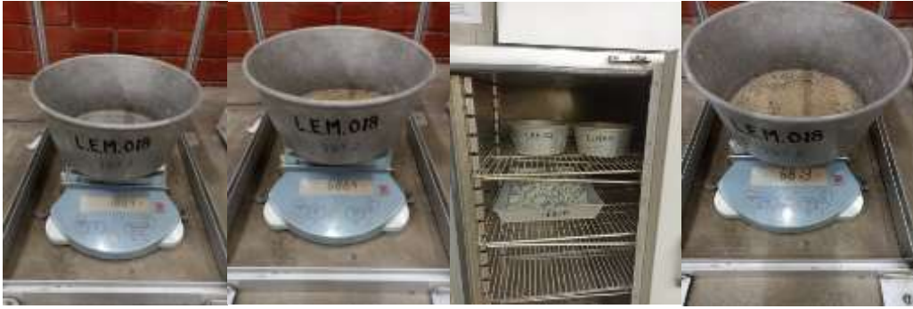
Foto 10: Ensayo par hallar el contenido de humedad del agregado fino.
