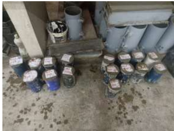
Foto 19: Probetas de hormigón.
