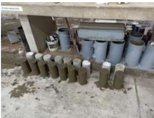
Foto 22: Probetas con sanado químico y sin curar.
