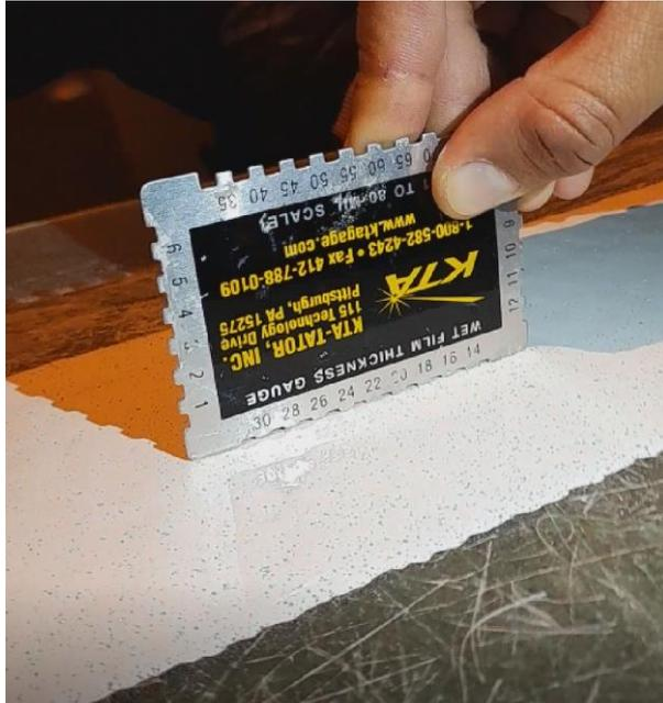
*Figura 12: Verificación de espesor de pintura*
