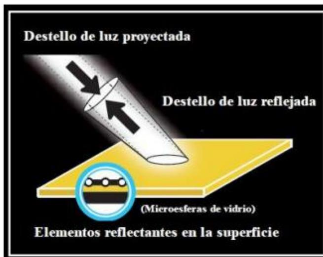
Figura 5: Retroreflexión de la Luz Adaptado
