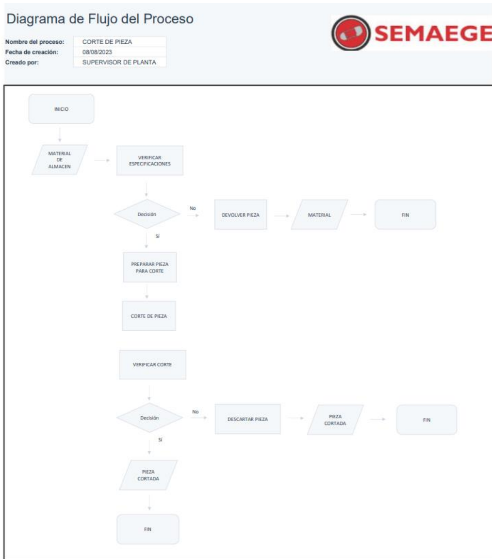
Figura 21 Diagrama de Flujo del proceso de corte
