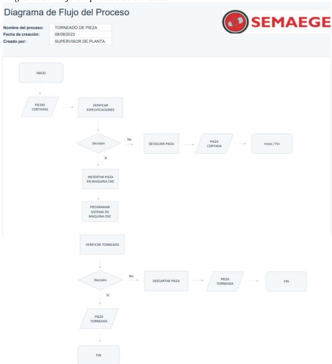
Diagrama de Flujo del proceso de torneado
