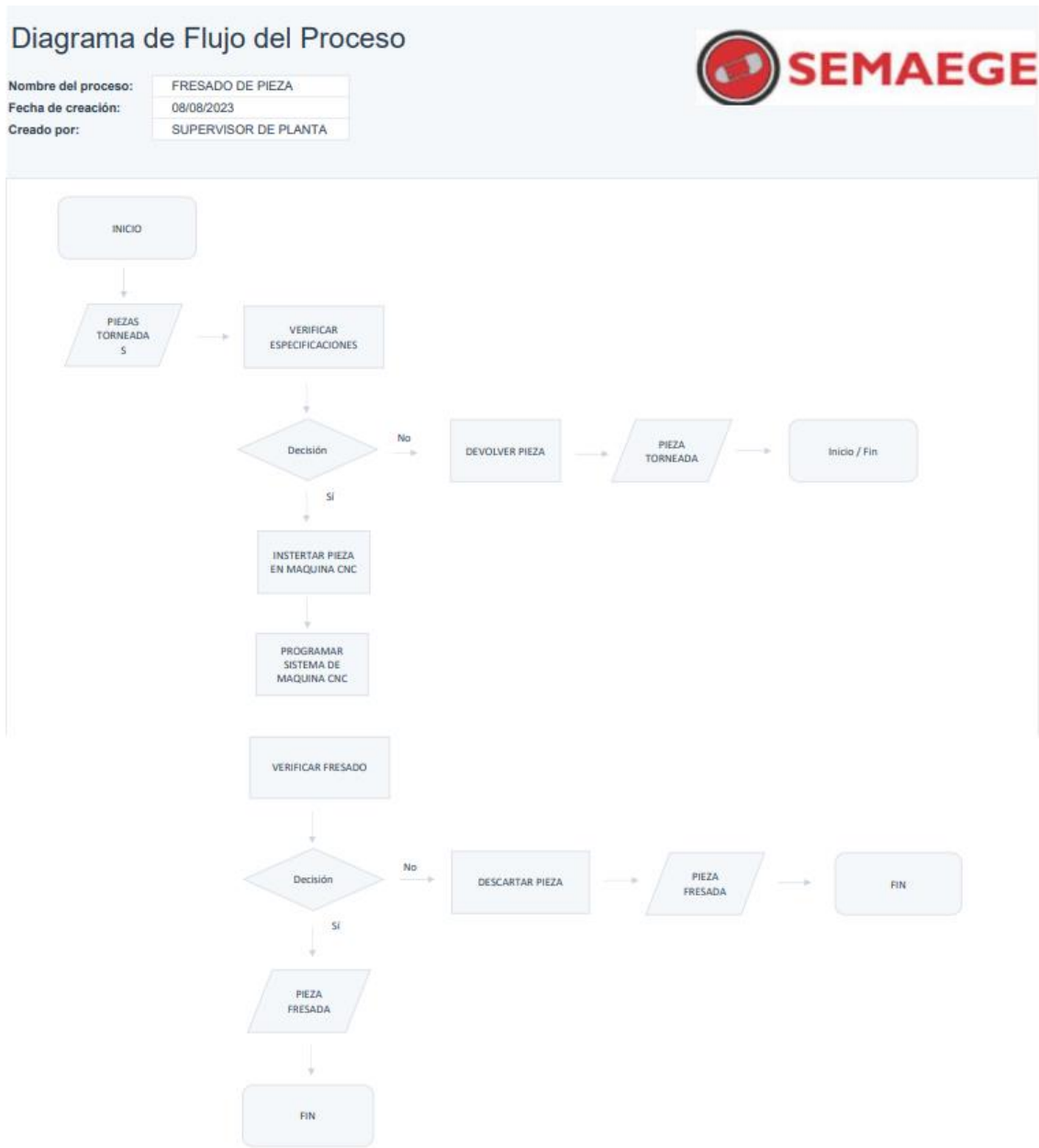
Figura 25 Diagrama de flujo del proceso de fresado
