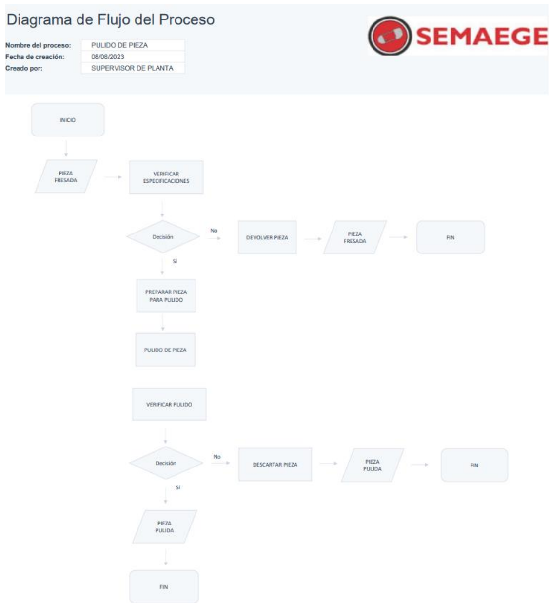
Figura 27 Diagrama de Flujo del proceso de pulido
