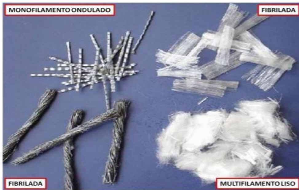
Tipos de fibra de polipropileno según su elaboración
