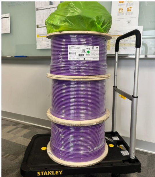
Rollos de cable UTP marca Siemon
