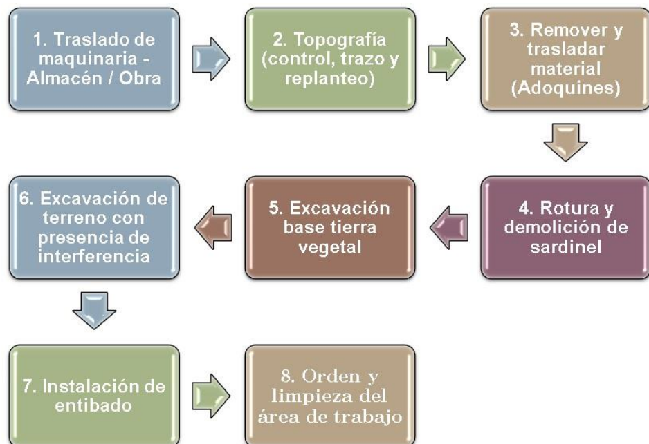
Figura 28: Tareas que conforman el ciclo Pre de excavación Fuente: Elaboración propia
