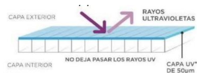
Figura 63 Funcionamiento capa protectora de UV
