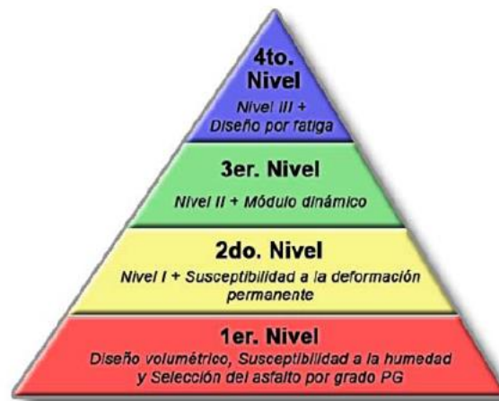
Figura 24. Niveles de diseño para mezclas asfálticas.
