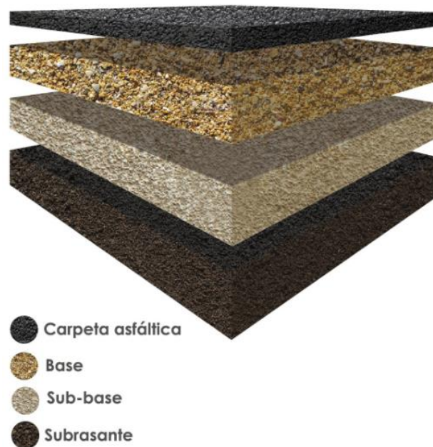
Figura 1. Capas de un pavimento flexible.
