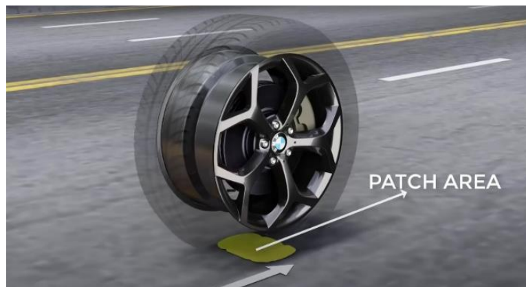
Figura 47. Área de contacto neumático-pavimento.
