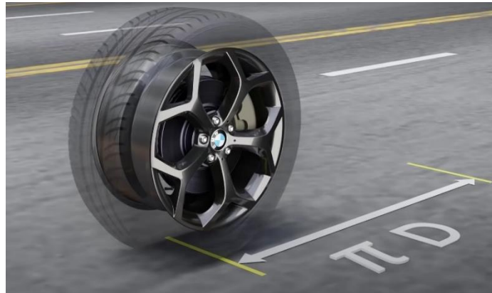
Figura 46. Distancia recorrida por perímetro de rueda.
