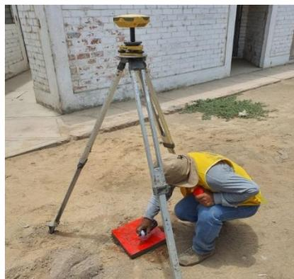
*Ilustración 2 Georreferenciación de puntos geodésicos e hitos monumentados*
