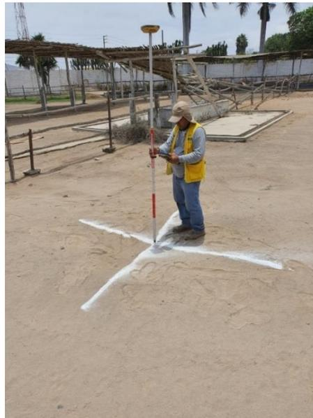
*Ilustración 3 Replanteo ubicación de marcas visibles para los puntos de control terrestre*
