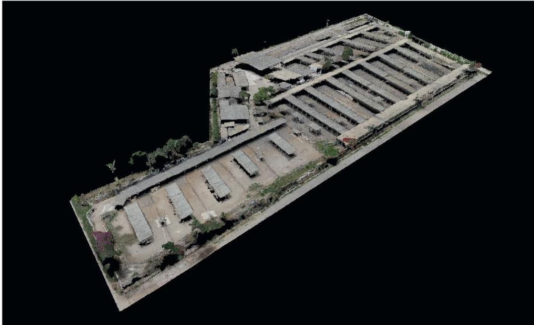
Ilustración 33 Nube de puntos y malla 3d del predio con la infraestructura existente
