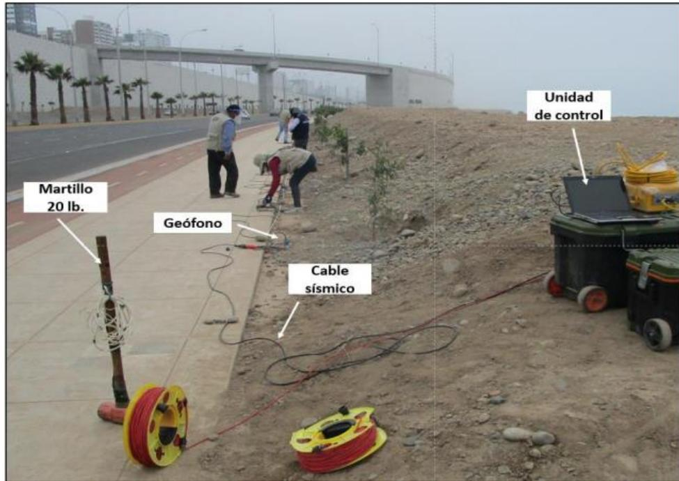
Figura 37: Equipos utilizados en la toma de datos por el método de MASW
