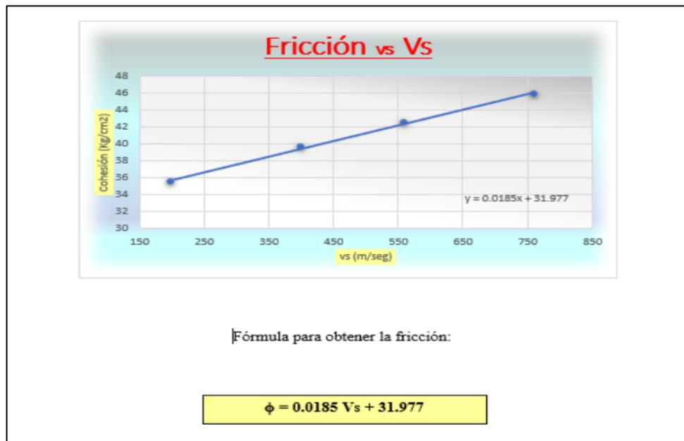
Figura 40: Curva de correlación para el ángulo de fricción ajustado a ensayos de corte directo
