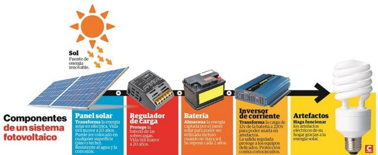
Figura 02.7. Componentes de un sistema fotovoltaico
