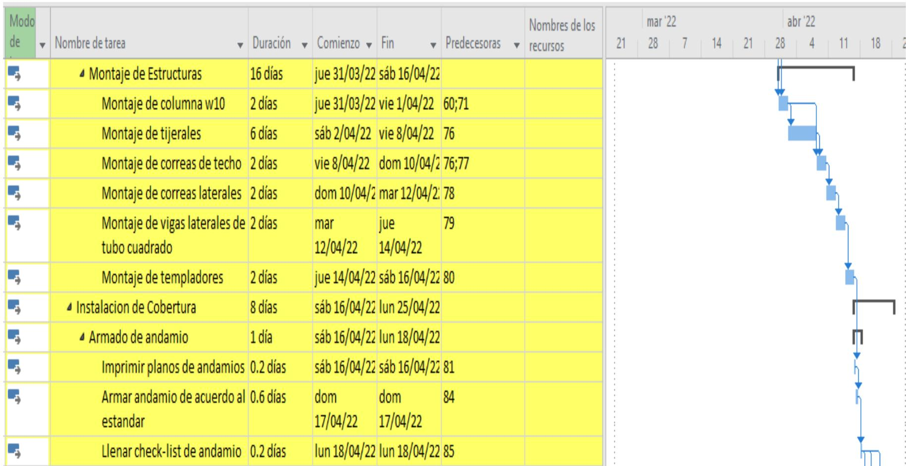
Figura N°. 24: Diagrama de Gant
