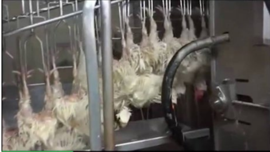
Figura 36: Etapa de escaldado de gallinas Fuente: Propia
