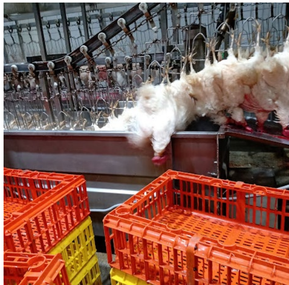
Figura 13: Etapa de escaldado de gallinas Fuente: Propia
