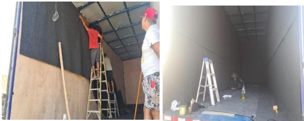
Figura N°32. Forrado de camiones con tapices
