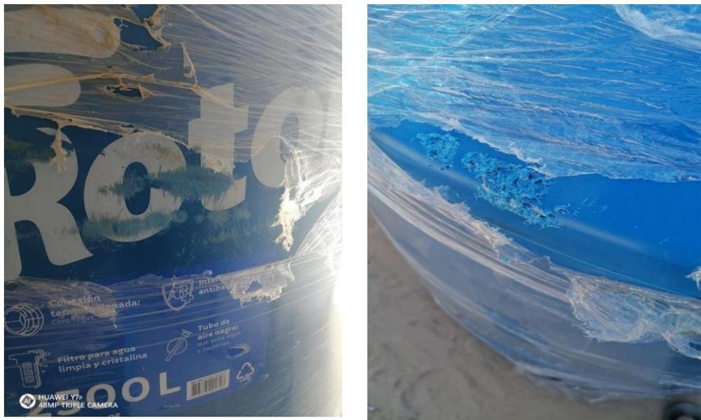
Figura N°25. Tanques mal embalados y deteriorados
