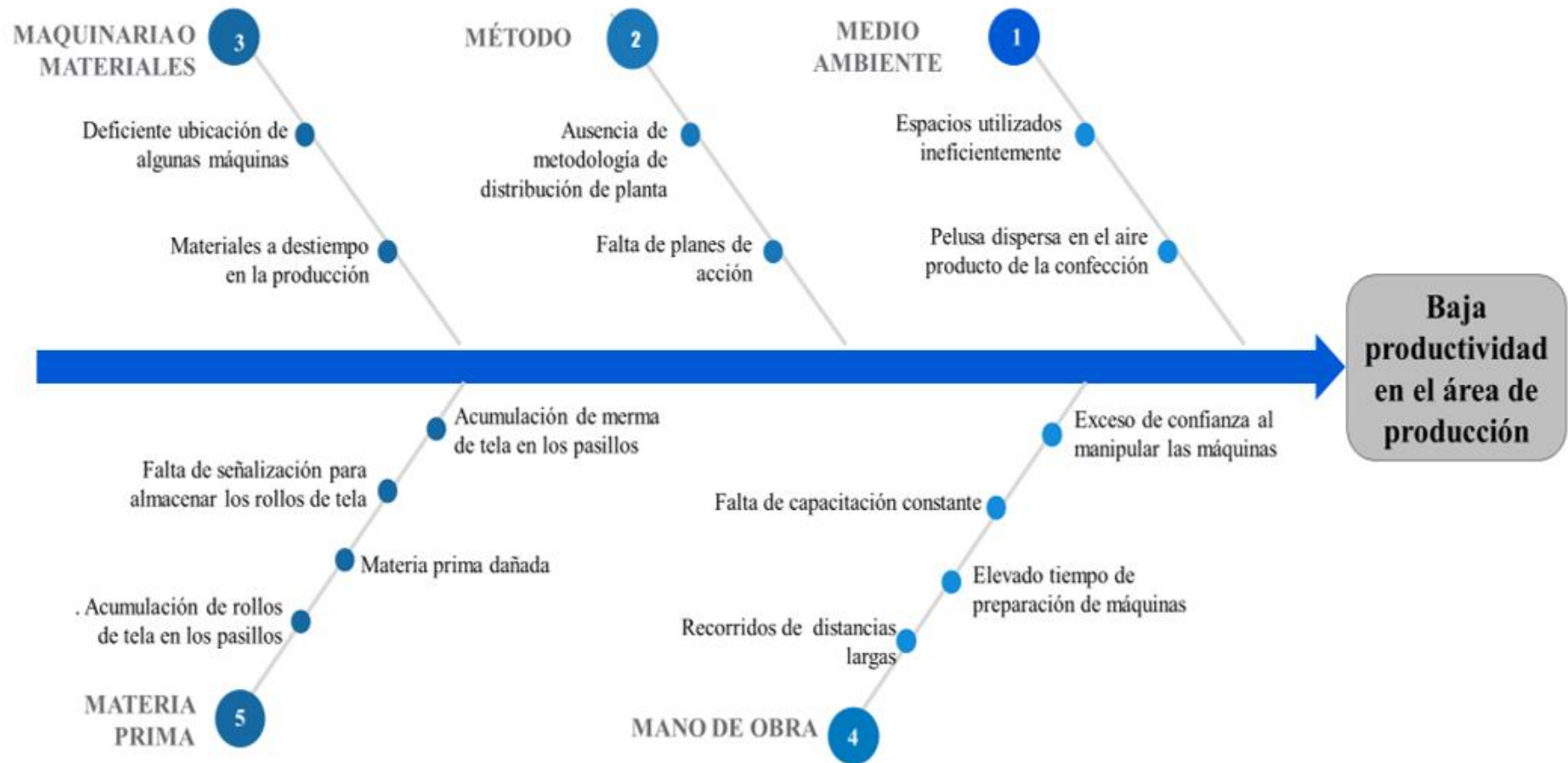
Figura 2: Diagrama de Ishikawa – Baja productividad en el área de producción Fuente: Empresa Confecciones Adrianito SAC Elaboración: Elaboración propia
