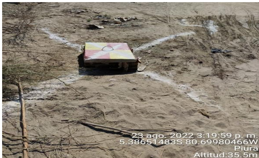
Figura 21. Punto de control 4 con GPS SOUTH Fuente: Registro fotográfico Tesistas
