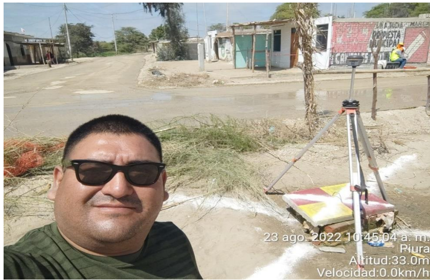
Figura 17. Posicionamiento del GPS South Galaxy G1 Fuente: Registro fotográfico Tesistas
