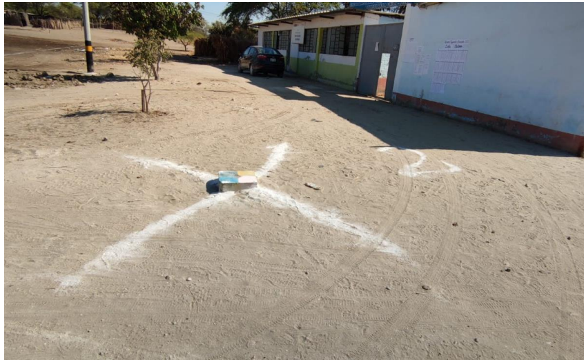
Figura 19. Punto de control 2 con GPS SOUTH Fuente: Registro fotográfico Tesistas
