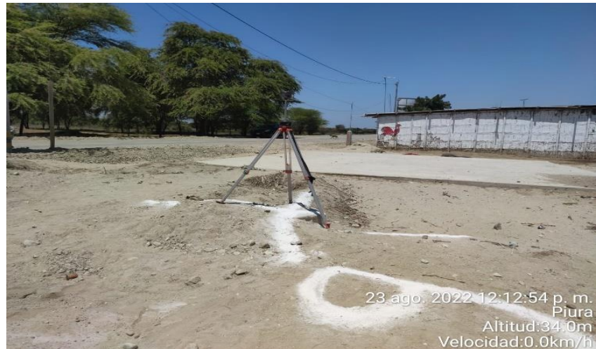
Figura 23. Punto de control 6 con GPS SOUTH Fuente: Registro fotográfico Tesistas
