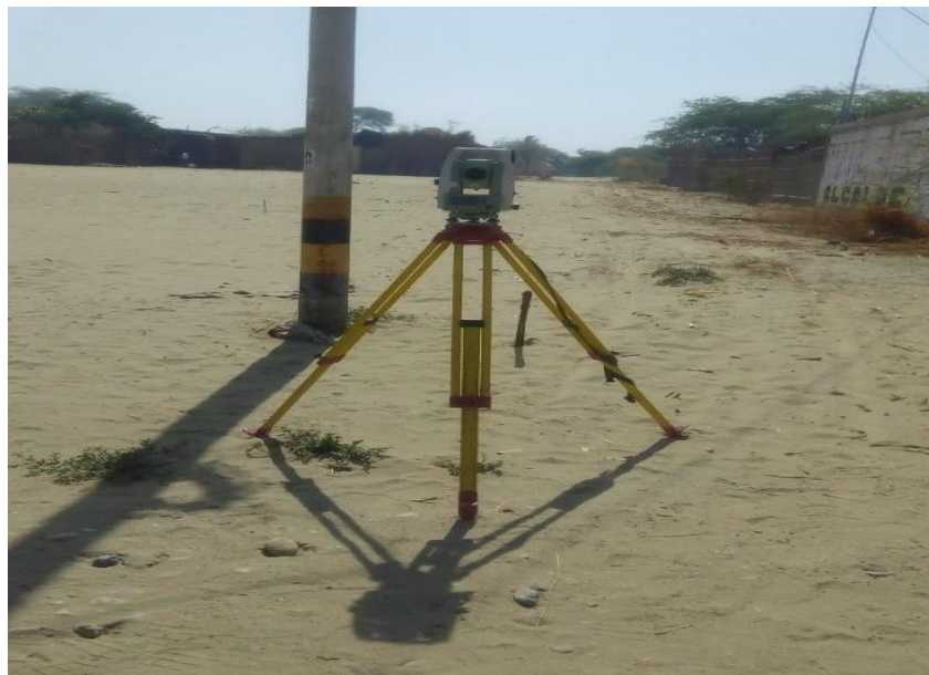
Figura 32. Estación Total en posicionamiento de PC 02 C.P Canizal Chico Fuente: Registro fotográfico Tesistas
