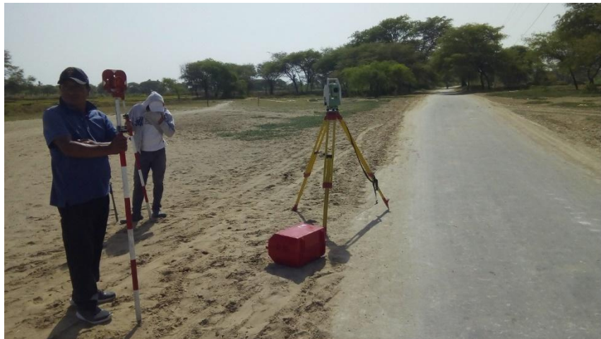
Figura 34. Lectura de puntos con el prisma de los extremos de la vía Fuente: Registro fotográfico Tesistas
