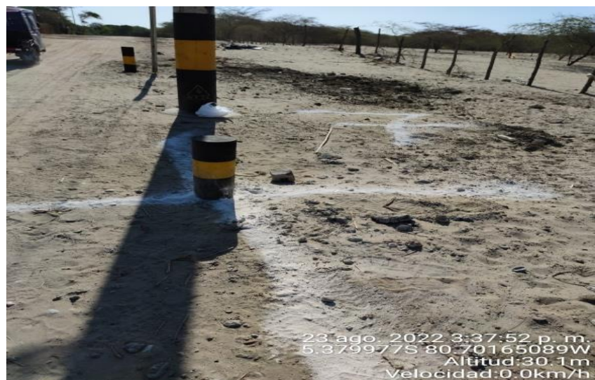
Figura 24. Punto de control 7 con GPS SOUTH Fuente: Registro fotográfico Tesistas
