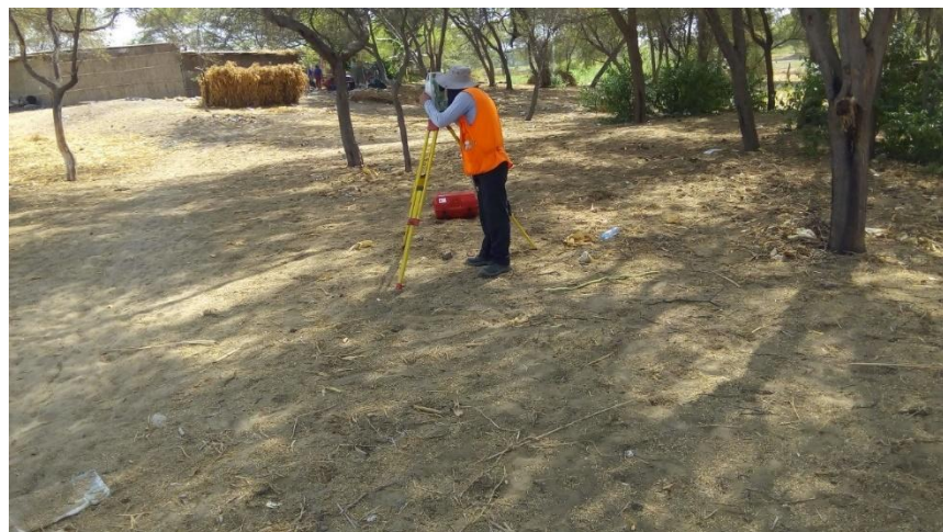
Figura 35. Lectura de puntos con la Estación Total Fuente: Registro fotográfico Tesistas
