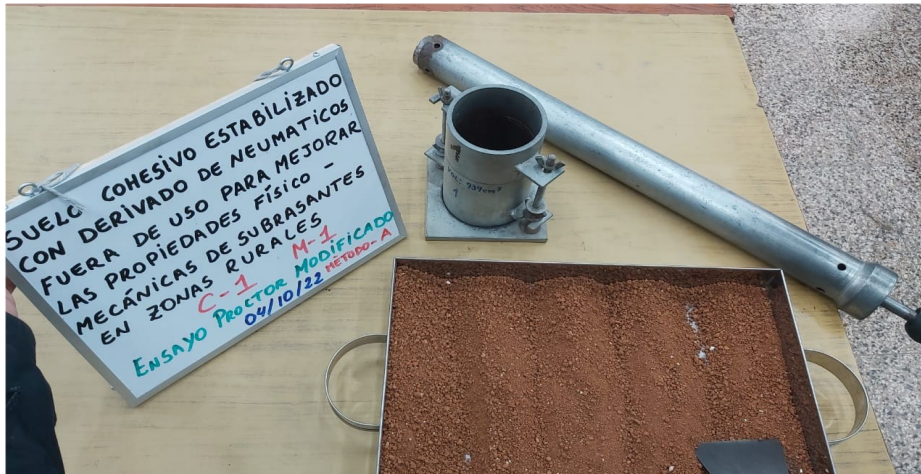
Figura N°47: Ensayo Proctor Modificado.
