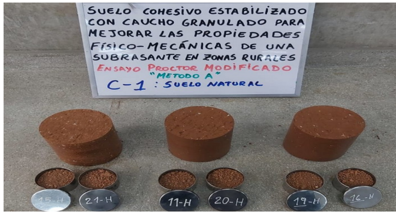
Figura N°49: Ensayo de Proctor Modificado, Método A del suelo natural.
