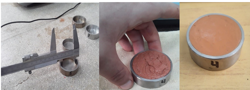
Figura N°46: Moldes para Límite de Contracción.
