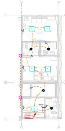
Nivel 01 - Alumbrado - Control PNP 1:50
