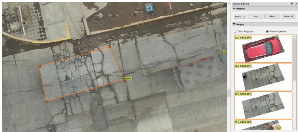
Figura 39: Ortofoto sin vehículos. Fuente: Elaboración Propia.
