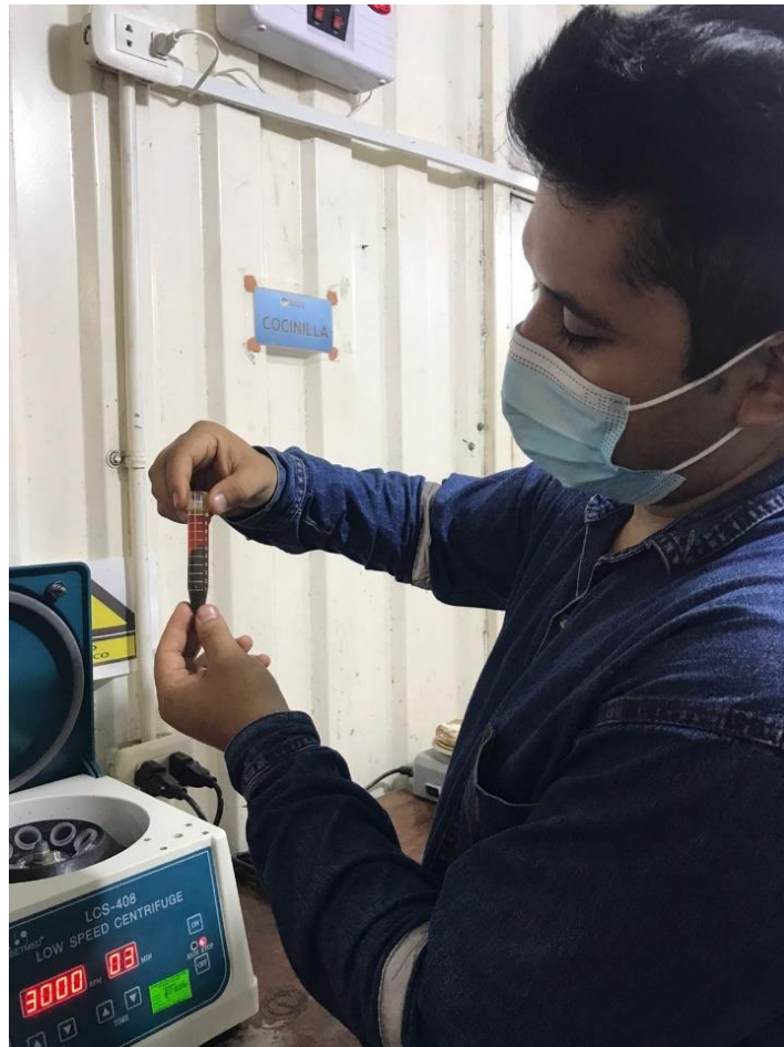
Figura 7: Control de calidad del aceite clarificado. Fuente: Elaboración propia
