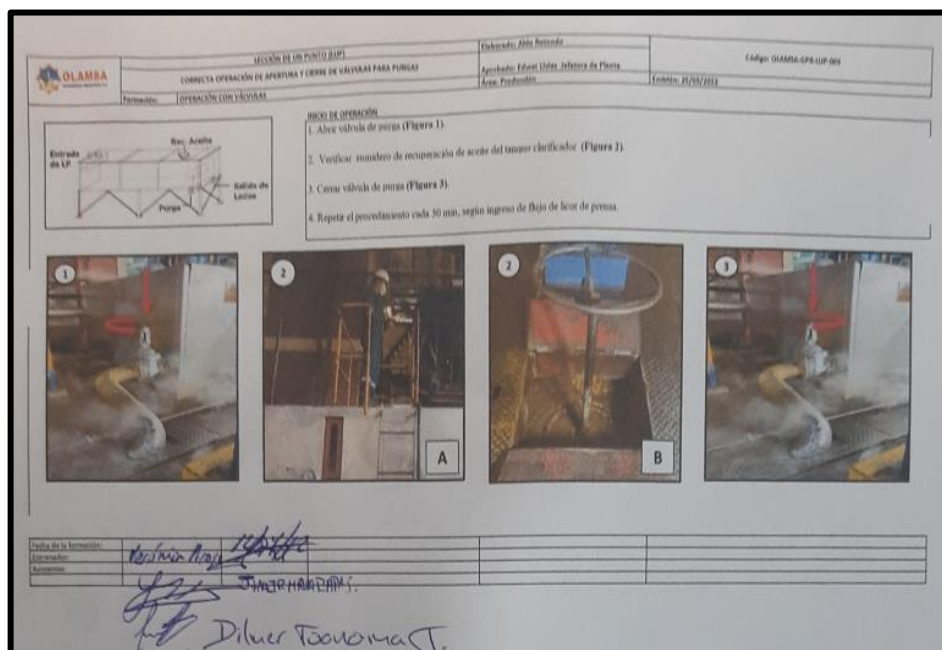
Figura 47: Difusión del OPL para la correcta operación de apertura y cierre de válvulas para purgas. Fuente: Elaboración propia.
