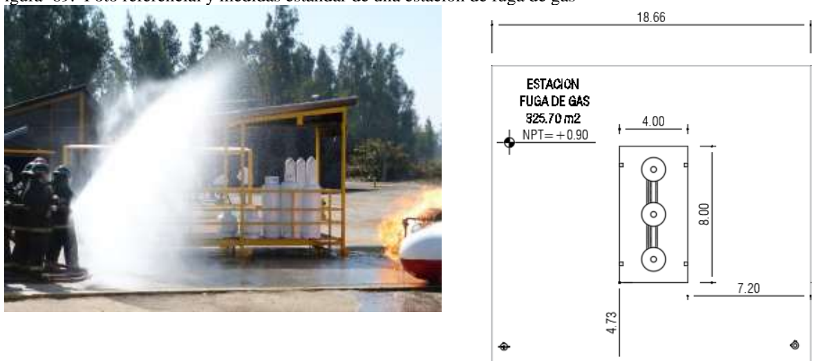
Figura 69. Foto referencial y medidas estándar de una estación de fuga de gas
