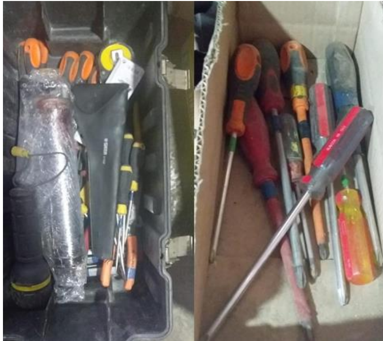
Figura 32: Herramientas en mal estado Fuente: Konecranes Perú SRL
