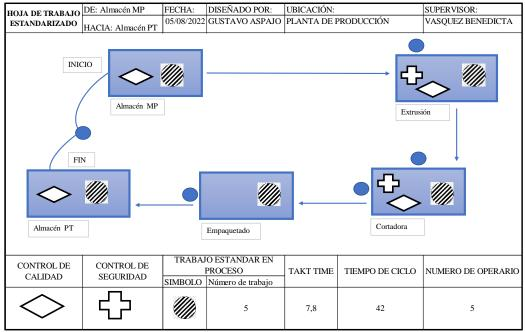
Figura 43: Hoja de Trabajo Estandarizado de la producción de bolsas de la empresa PLASTISIN S.R.L. después de la implementación
