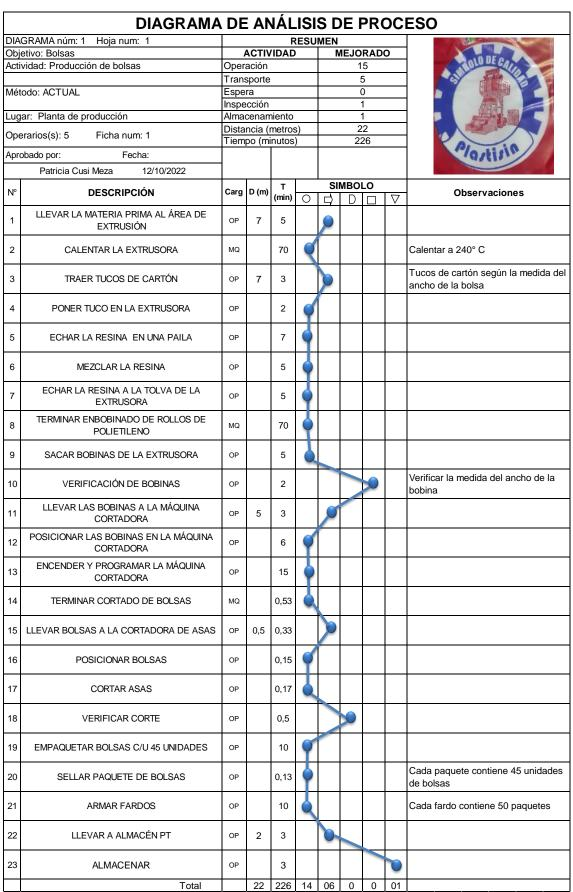
Figura 50: Diagrama de Análisis del Proceso de la empresa PLASTISIN S.R.L. después de la implementación
