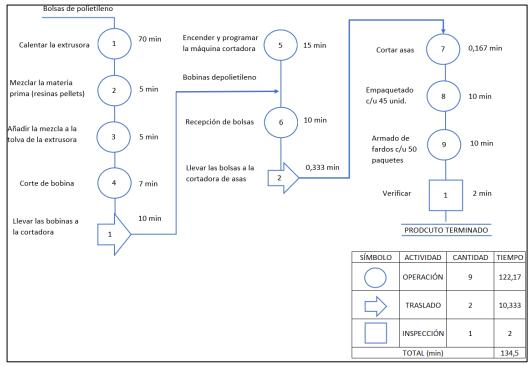
Figura 25: DOP de la producción de bolsas de polietileno de PLASTISIN S.R.L.
