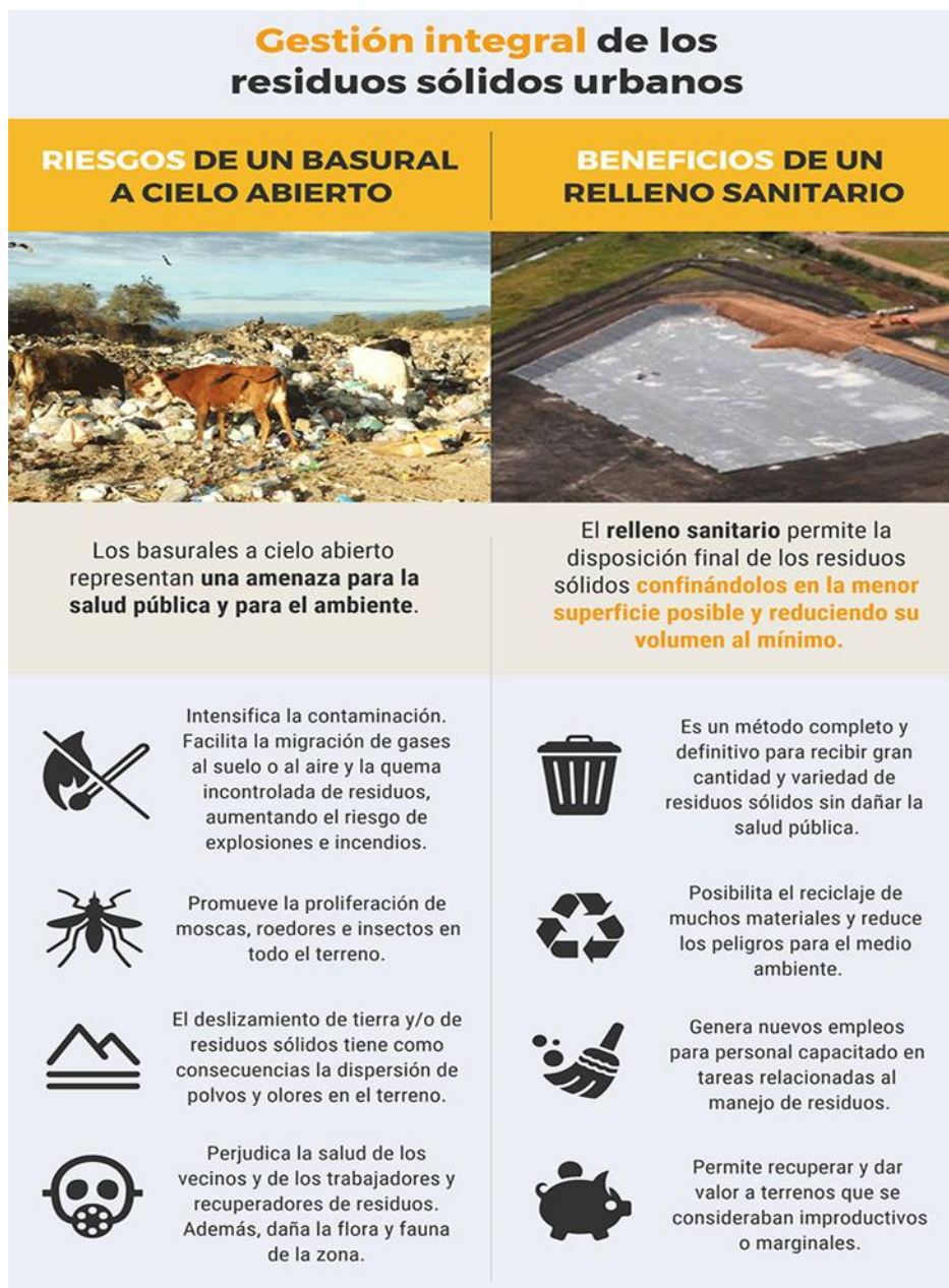
Figura 13: Infografía: Diferencias entre un basural y un relleno sanitario.
