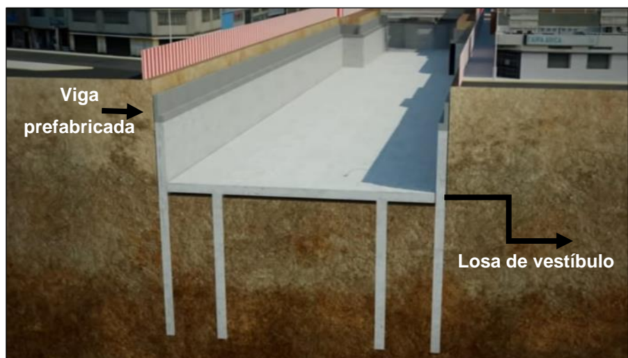
Figura N° 48: Losa de vestíbulo y viga prefabricada. Fuente: Andina agencia peruana de noticias (2022).
