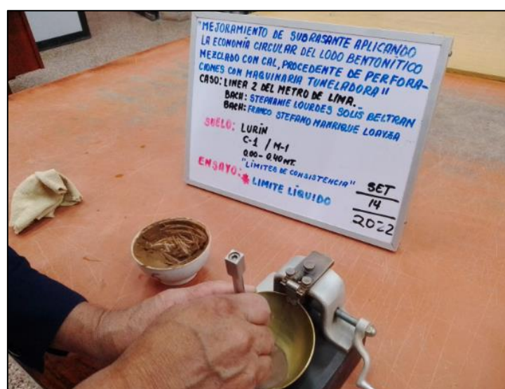
Figura N° 74: Muestra en copa Casagrande. Fuente: Elaboración Propia.
