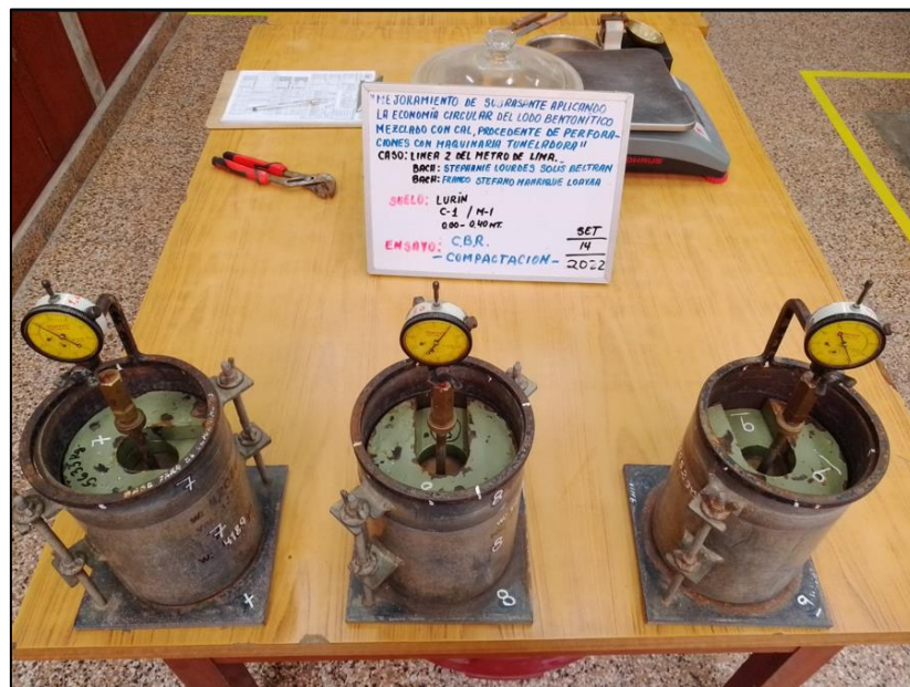
Figura N° 88: Moldes con suelo de Lurín para 56, 25 y 12 golpes antes de saturar. Fuente: Elaboración Propia.
