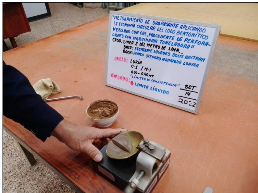
Figura N° 75: Golpes en la copa Casagrande. Fuente. Elaboración Propia.
