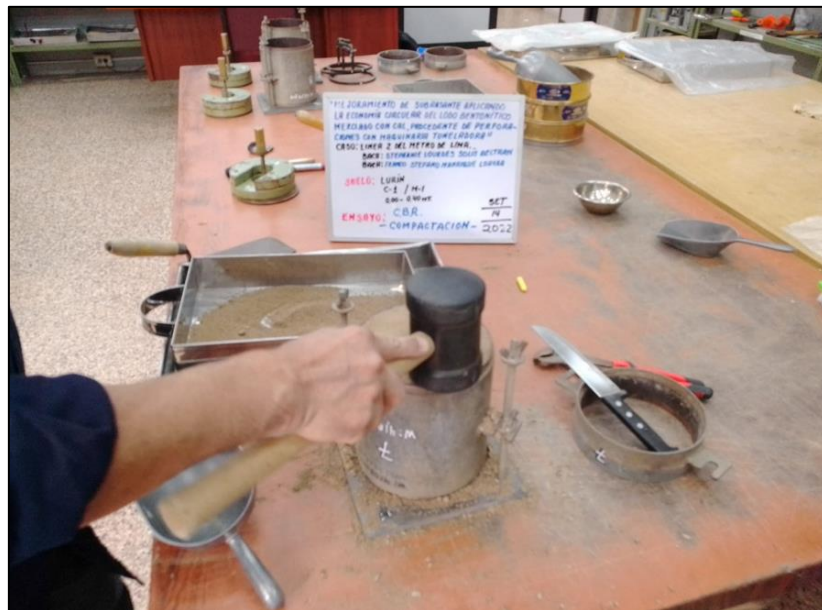
Figura N° 86: Compactación CBR suelo de Lurín. Fuente: Elaboración Propia.
