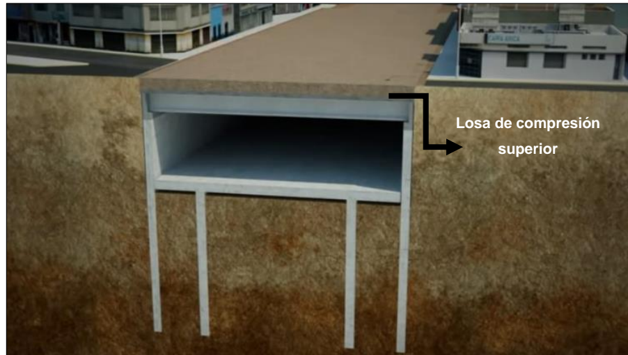
Figura N° 49: Losa de compresión. Fuente: Andina agencia peruana de noticias (2022).
