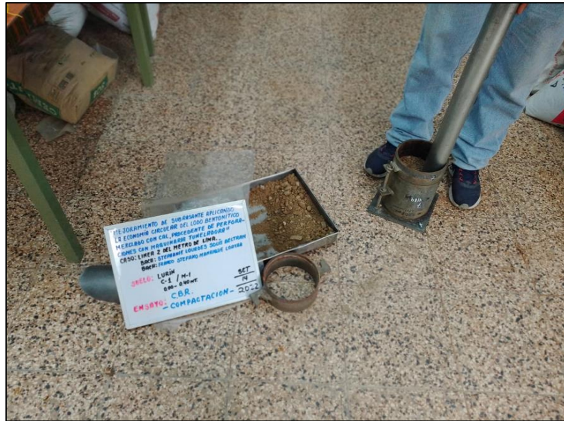
Figura N° 85: Compactación de ensayo de CBR suelo de Lurín. Fuente: Elaboración Propia.
