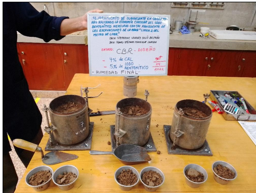
Figura N° 92: Ensayo CBR suelo de Lurín con 4% cal y 5% bentonita. Fuente: Elaboración propia.
