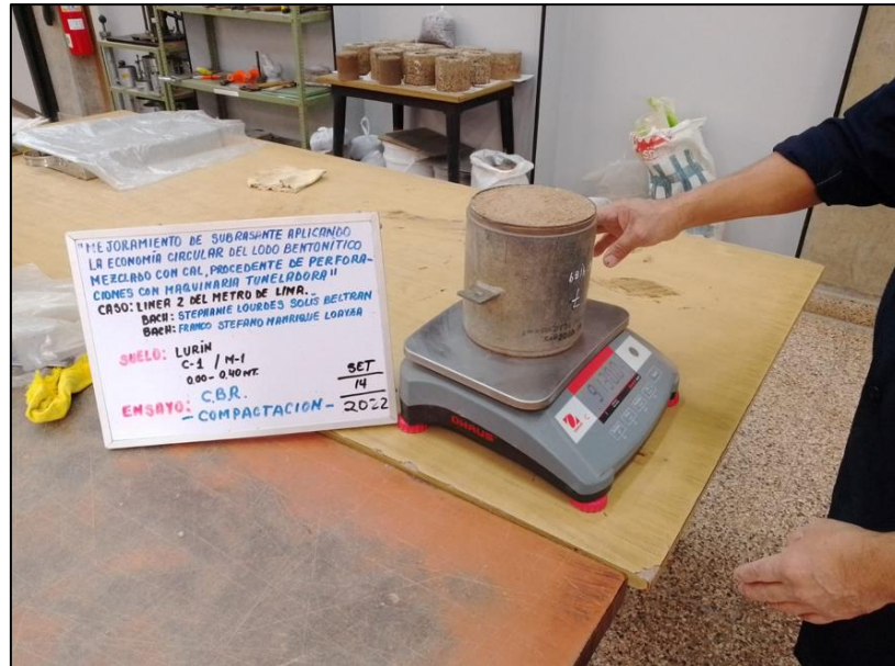
Figura N° 87: Peso del suelo de Lurín con molde de CBR. Fuente: Elaboración Propia.
