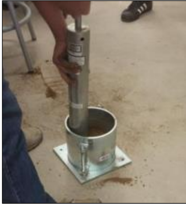
Figura N° 31: Compactación del espécimen para el ensayo de proctor modificado. Fuente: Moale A. y Rivera E. (20 18).
