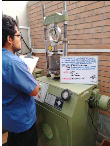
Figura N° 91: Molde con suelo de Lurín en ensayo de CBR. Fuente: Elaboración Propia.
