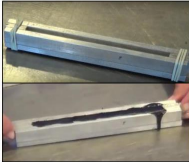
Figura 14. Molde de la viga.
