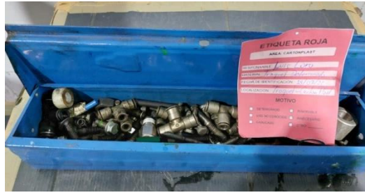
Figura 24: Pernos y uniones oxidadas Fuente: Datos de la empresa
