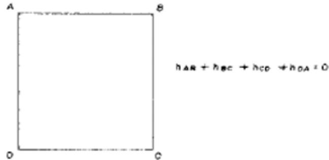
Figura N° 24: Pérdida de carga en circuito método Hardy Cross
