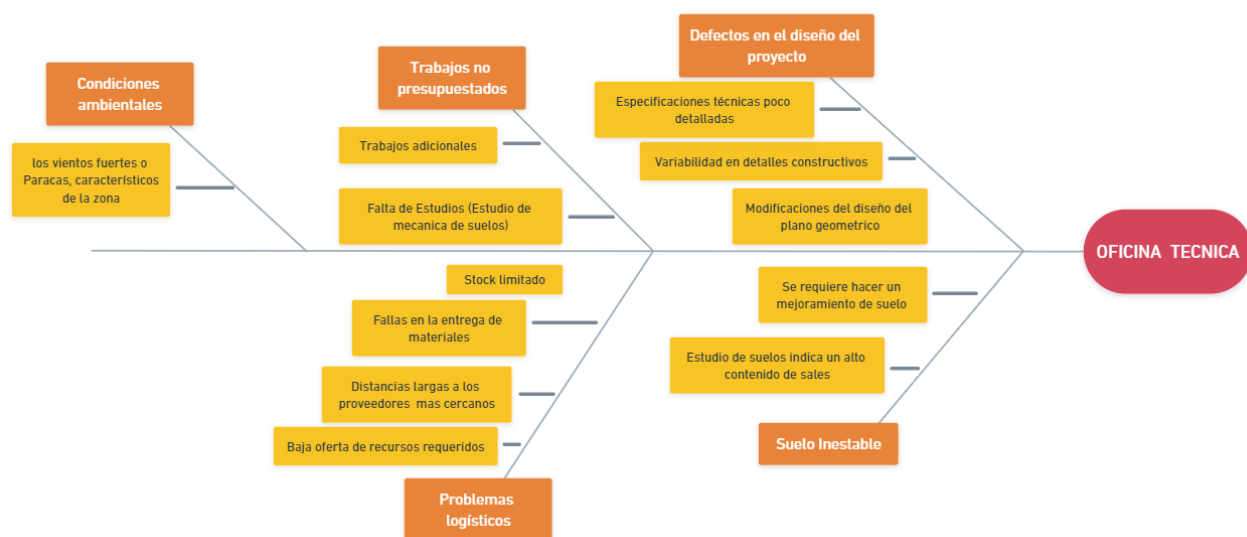
Figura N 20. Diagrama de Ishikawa del Área técnica en la ejecución de una pavimentación rígida. Nota: Elaboración propia.
