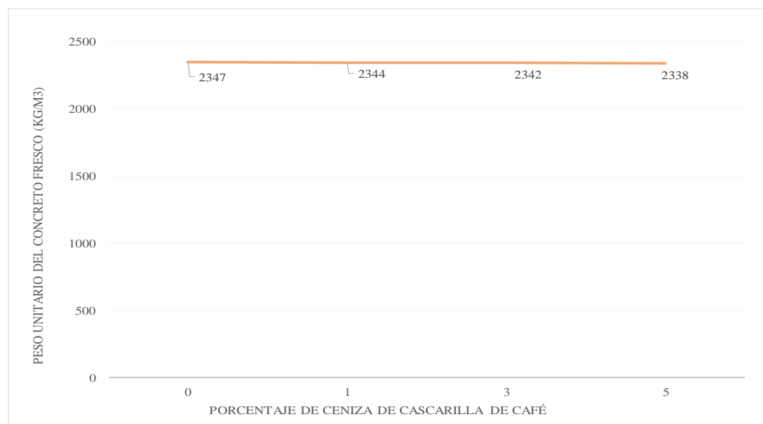
Figura 18 Peso Unitario (Kg/m 3 ) VS Porcentaje de ceniza de cascarilla de café para el concreto f'c 210 kg/cm 2 .
